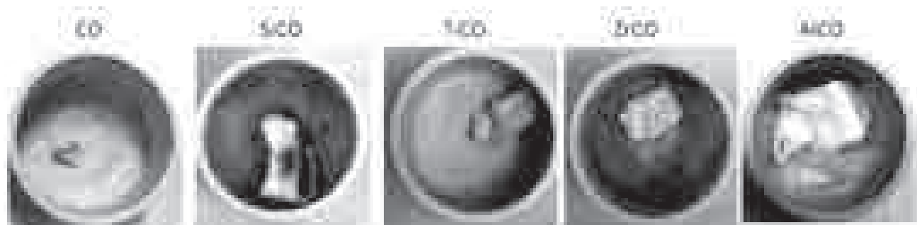
شکل ۲ باقی مانده‌های پارچه‌های پنبه‌ای خالص و عمل شده با سل-ژل (نمونه‌ها وزن اولیه یکسان دارند) بعد از رفتار حرارتی در مافل
